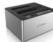
Lorsqu'ils sont connectés à un ordinateur, les deux disques durs sont détectés comme deux lecteurs indépendants en mode JBOD. Sans PC, vous pouvez cloner un disque dur de la simple pression d'un bouton. Vous pourrez même cloner un disque dur amorçable sans système d'exploitation.
