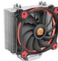
Un ventilateur de 120 mm est installé pour améliorer le flux d'air, et produit des performances de refroidissement impressionnantes avec une conception améliorée à 11 pales. Les roulements hydrauliques, pour un fonctionnement silencieux, garantissent un bruit ultra-faible. L'anneau à LED breveté maintient une couleur et une luminosité uniforme, et l'éclairage est visible de tous les côtés et sous tous les angles.
